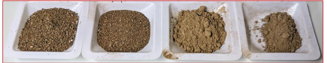
Kuva 1: kaksi karkeampaa pohjatuhkaa ja 2 hienoa lentotuhkaa
