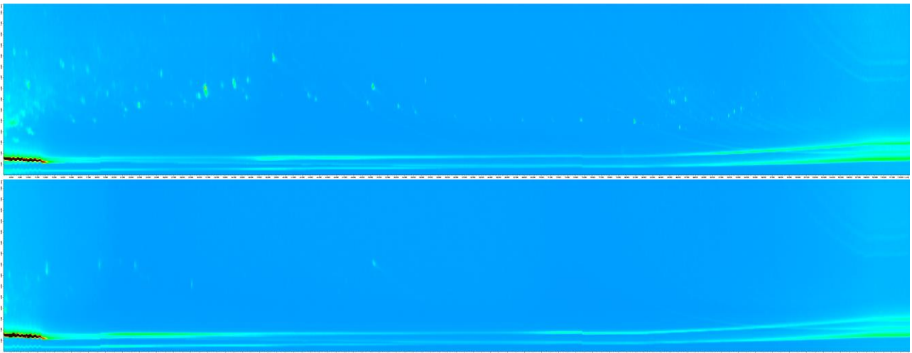
Kuva 20. Erään tislefraktion öljyfaasi (yläkuva; laimennos 1:400) ja vesifaasi (alakuva, laimennos 1:100) 2D-GC-MS:llä karakterisoituna. Öljyfaasissa näkyy selvästi enemmän yhdisteitä, huolimatta 1:4 laimennoserosta.
