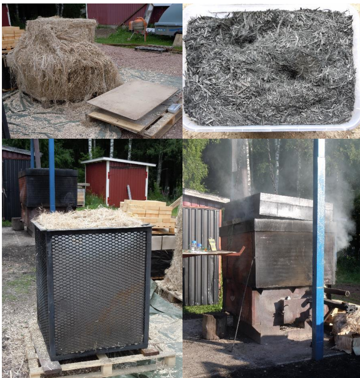
Kuva 18. Biohiilen valmistuskokeilu hankkeen aikana kasvatetusta kuituhampusta Salohiilellä.
