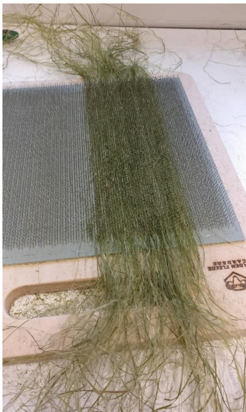
Kuva 24. Hamppukuitulujitteisten pitkäkuitukomposiittien valmistusta.
