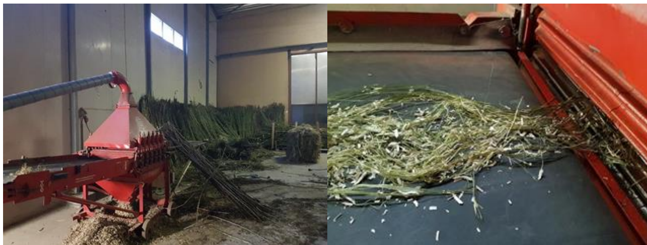
Kuva 12. Loukku, taustalla korsia kuivumassa ja "hampukkuitupaali". Päistäre tippui loukun alle.
