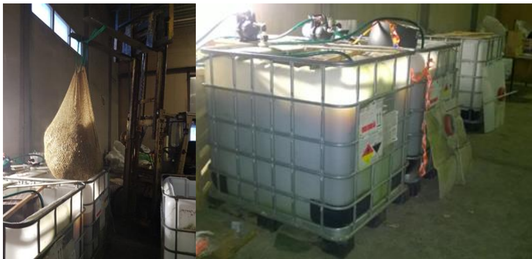
Kuva 13. Entsymaattisesti liotetusta materiaalista valutetaan irtovesi pois ennen huuhtelualtaaseen siirtämistä.
