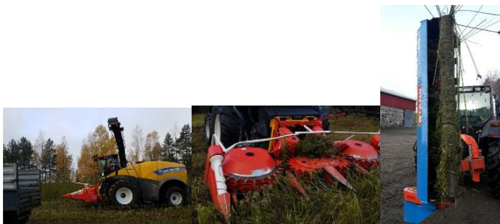
Kuva 5. Ajosilppuri, jossa oli maissinkorjuupää. Piennarmurskaimeen kiertynyttä hampua oikealla.
